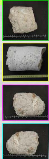
*Le malte della Cupola del Brunelleschi (XV sec.) – Firenze sono un esempio di malta antica leggermente idraulica (calce prodotta da cottura di calcare Alberese) di ottima qualità.*
